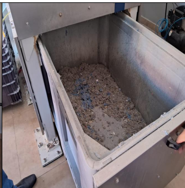
Figura 31 – Máquina autoclavagem (importada) que faz o tratamento dos resíduos hospitalares gerados para posterior coleta da empresa Cheiro Verde Ambiental que dará a destinação correta deste resíduo de interesse ambiental.
